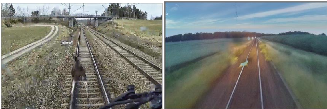
Figur 3. Vänster: Flyende älg strax innan den blev påkört av tåget. Älgen varseblev tåget då lokföraren varnade med tyfonen upprepade gånger, men försökte tyvärr fly längs med järnvägen i stället för att lämna banvallen. Kollisionen ledde till omfattande skador på tågfordonet (X2000). Höger: Ett rådjur försöker korsa spåret omedelbart framför tåget men missbedömer tågets hastighet och blir påkört. Endast mindre skador uppstår på loket.
