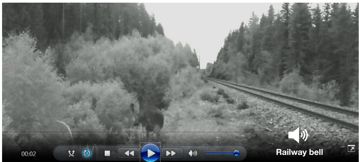
Figur 11. Exempel på en elg som stopper på vei opp mot jernbanelinja når den aktiverer MASS enheten (övre bild). Når elgen hører lyden fra MASS-enheten (etter 2 sekunder, nedre bild) flyr den tilbake in i skogen (i dette eksempel hørdes ett varselsignal (ringklocka) fra jernbaneovergang).
