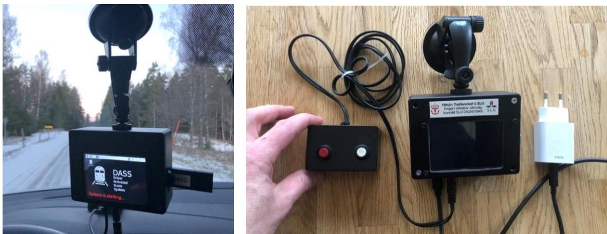
DASS står for 'Driver Activated Scare System' og er et programmerbart videokamera utviklet innenfor prosjektet, som kan kobles til en ekstern høyttaler. DASS-kameraet justeres med hjelp av innstillingar fra en USB-nøkkel. Når man skal laste ned filer fra DASS-enheten er det viktig at filen "DASS.ini" ligg i "INPUT"-mappen på nøkkelen. Videoen lagres i mappen "OUTPUT".
