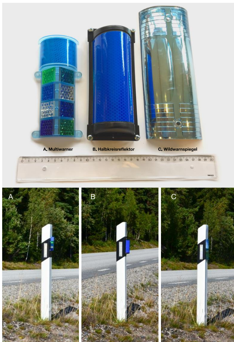
Bild 3. Tre reflekortyper som ingick i testet: A: multivarnare med "kattögon"; B: blå reflektorfolie på en halvcirkelyta; C: viltspiegel.
